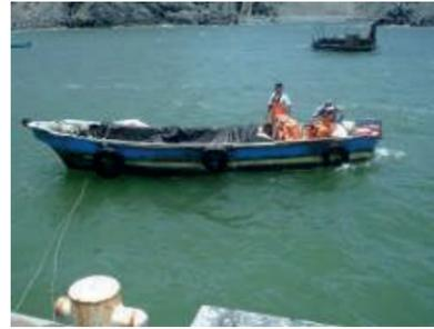
Fig. N° 31: Embarcación de fibra 22 de eslora
