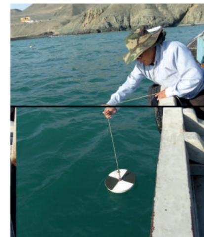
Fig. N°12: Medición de transparencia del agua
