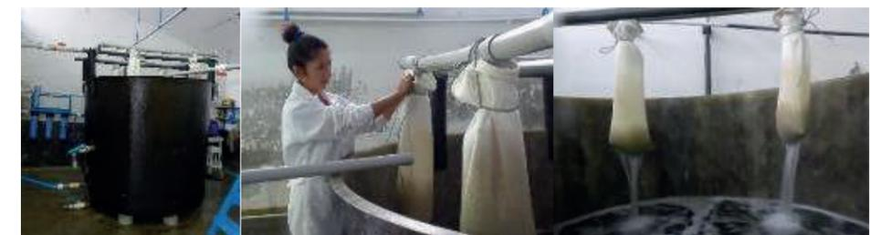
Figura N° 43. Tanque de acumulación de agua de mar tratada.
